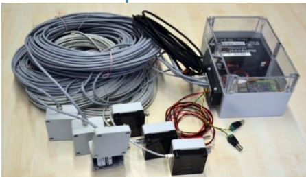
Mess-System für Schall und Schwingungen mit externen Drucksensoren
